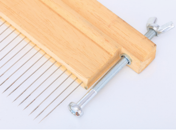
Görsel 2.12: Diş yükseklikleri ayarlanabilen ebru tarakları, sabit diş yüksekliği olan taraklara göre kullanım kolaylığı sağlamaktadır.
